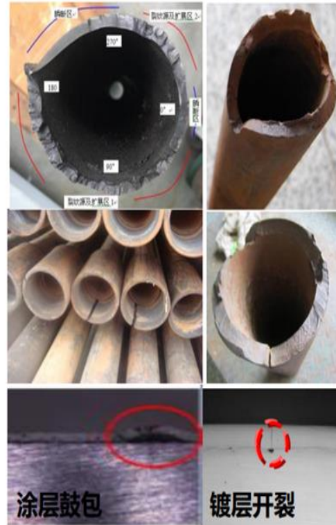
现场应力腐蚀开裂及涂镀层失效问题
