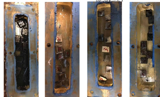
(A) No treatment (B) 50 ppm THPS (C) 50 ppm THPS + 100 nM Peptide A (D) 100 ppm THPS
